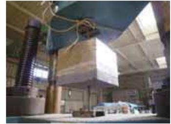
写真-4 引抜き試験
