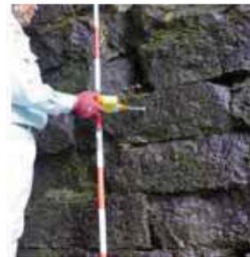
写真-5 石材のシュミットロックハンマー計測
