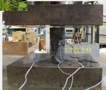
石材の圧縮強度試験
