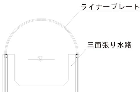
図-4 改修されたトンネル構造
